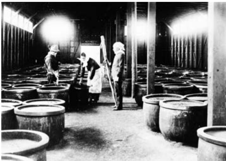
川崎工場の道明寺甕（塩酸塩冷却晶析中）
